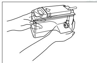
**3** Продвиньте бачок в положение "ПОЗИЦИЯ БАЧКА", при этом фиксатор крышки бачка должен быть направлен к вам.
